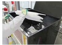
発泡スチロール(PS)などは、リサイクルセンター内の熔融機で熔融後、冷却してインゴッドとなります。
